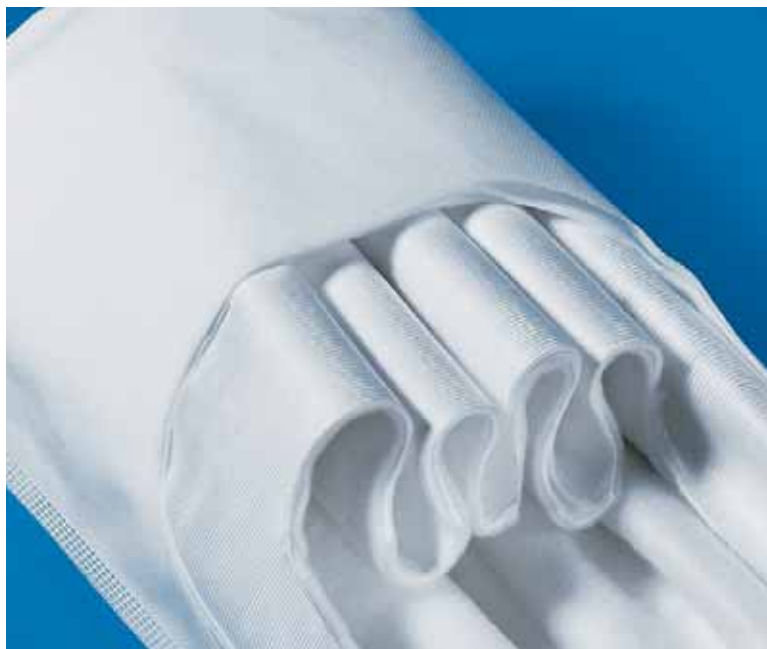
Um pré-filtro plissado proporciona uma alta superfície de filtração (aproximadamente 3 m²) adequado para remoção de géis e sólidos antes de atingir a camada de filtro final.
