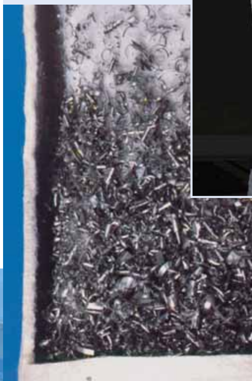
Parti metalliche raccolte durante la filtrazione in un impianto lavapezzi
